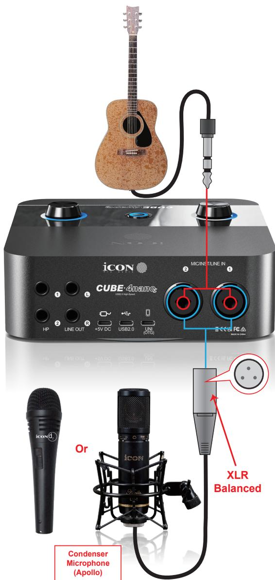
**Attenzione:** Per l'utilizzatore di microfono dinamico, assicurarsi che l'interruttore di alimentazione phantom a +48V sia su "disattivato" prima di collegare il microfono, altrimenti ciò può danneggiare il microfono.
