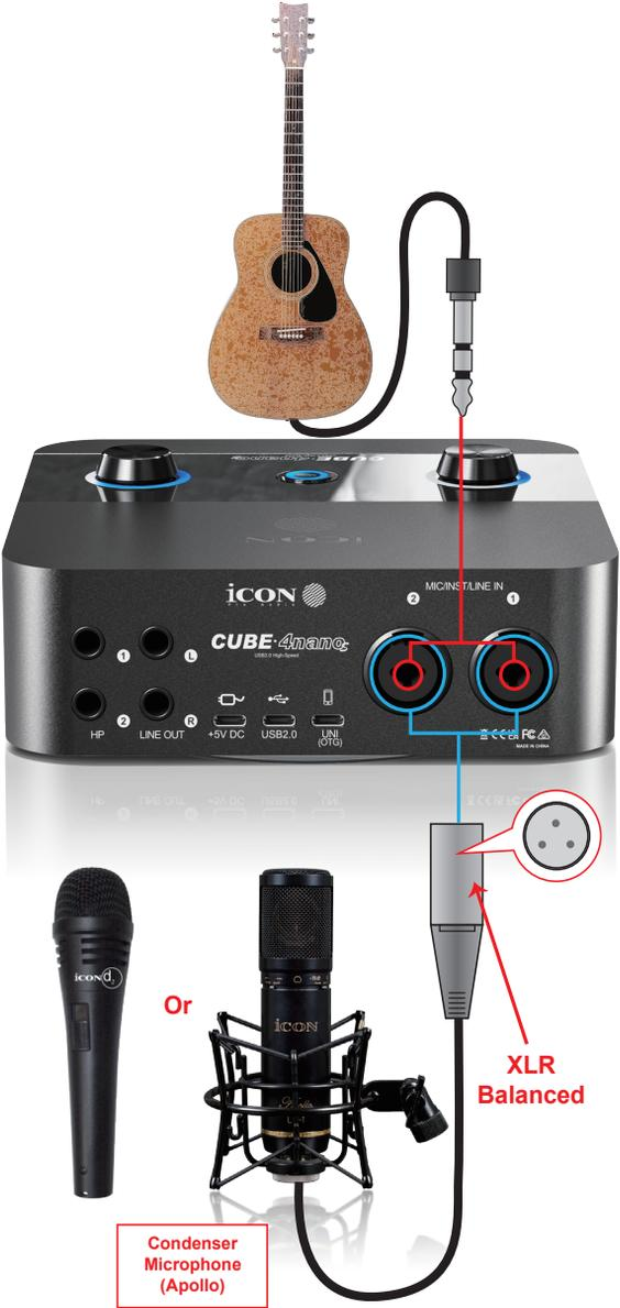
**Remarque:** Lors d'utilisation de microphone dynamique, assurez-vous que l'interrupteur de l'alimentation fantôme +48V est sur « désactiver » avant de brancher votre micro, autrement ce dernier risque d'être endommagé.
